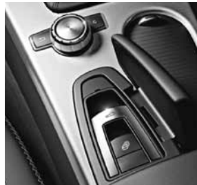
Dach-Bedieneinheit und zentrales Bedienelement
